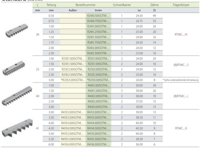
Anmerkung: 3.00 ISO Schneidplatten passen nicht in den Trägerkörper RTMC2517.... Für die CNC Programmierung bei Außengewindeplatten 3.0 ISO (D2 + 0.5mm)
