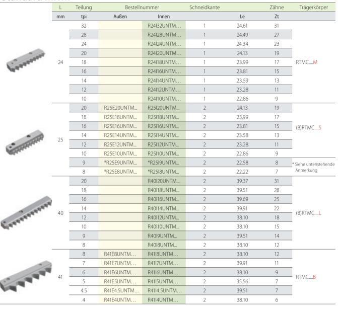
Anmerkung: 8 UN & 9 UN Schneidplatten passen nicht in den Trägerkörper RTMC2517.... Für die CNC Programmierung bei Außengewindeplatten 8 UN (D2 + 0.5mm)
