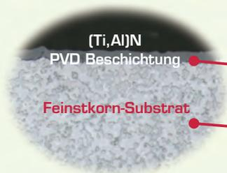
**Hohe Prozesssicherheit durch die Kombination von einzigartiger Beschichtung und extrem zähem Substrat**
