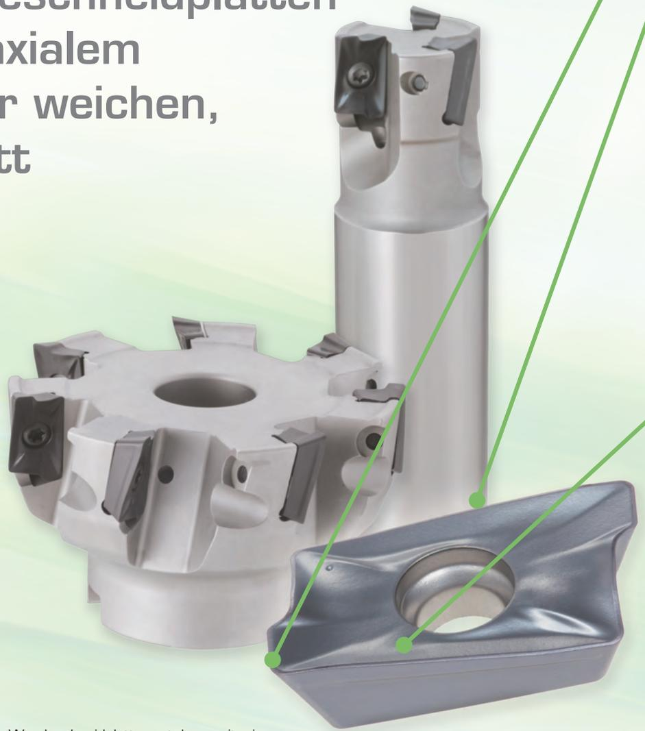
Universalität und Präzision sind die Markenzeichen der neuesten Entwicklung aus dem Hause **Tungaloy**. Die innovative **TungRec** Fräserfamilie deckt eine Vielzahl unterschiedlichster Anwendungsprofile ab. Höchste Präzision in der Semi-Schlichtbearbeitung mit spiegelähnlichen Oberflächen und die Bearbeitung exakter 90° Schultern ohne Versatz zeichnen die **TungRec** Fräserfamilie aus.
